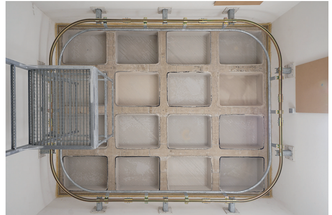
Abbildung 4: Am Schallprüfstand eingebaute Probekörper mit ausgewerteten Ergebnissen; © ITE, TU Graz
