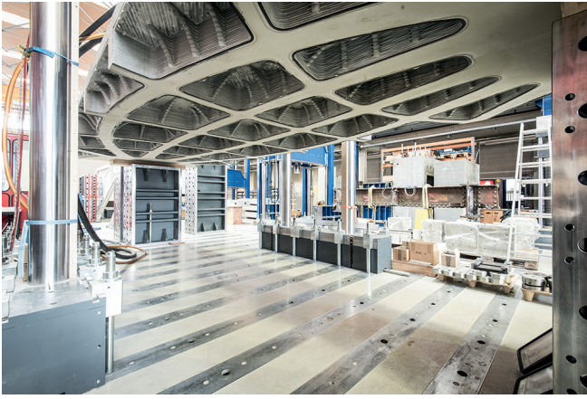
Abbildung 2: Großversuch SLS und ULS zweiachsig; rechts: Großversuch SLS und ULS einachsig; © ITE, TU Graz
