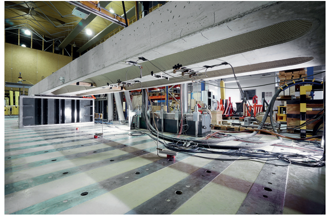
Abbildung 2: Großversuch SLS und ULS zweiachsig; rechts: Großversuch SLS und ULS einachsig; © ITE, TU Graz
